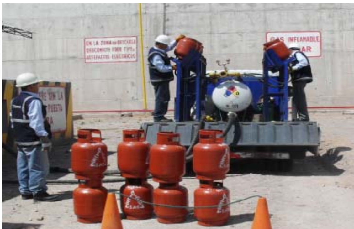
Vaciado del contenido de GLP de los cilindros al módulo de trasiego de OSINERGMIN.
