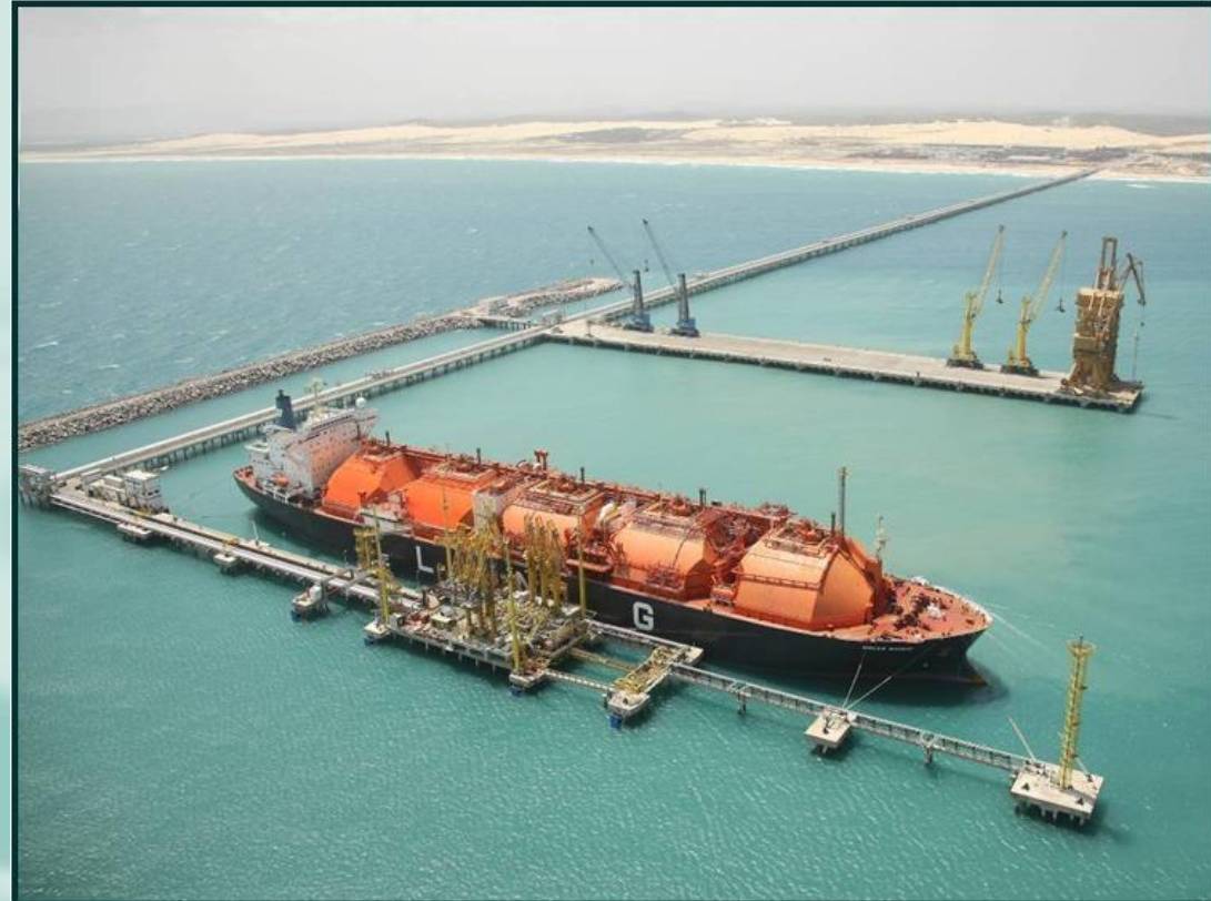
Buque metanero con almacenamiento y regasificación onboard
